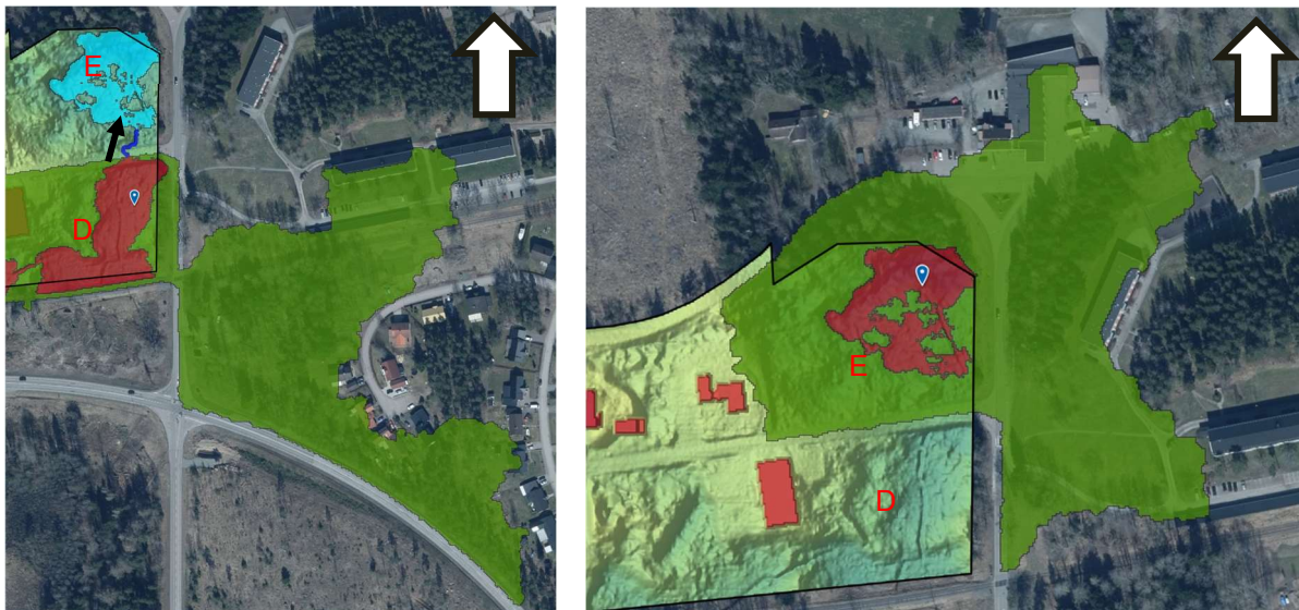
Figur 9. Till vänster: Avrinningsområde för område D, Till höger: Avrinningsområde för område E. Grön färg markerar avrinningsområdet, röd färg är utbredning av lågpunkten som är markerad, blått område är området som lågpunkten bräddar till och svart pil visar rinnriktning vid bräddning av markerad lågpunkt.
