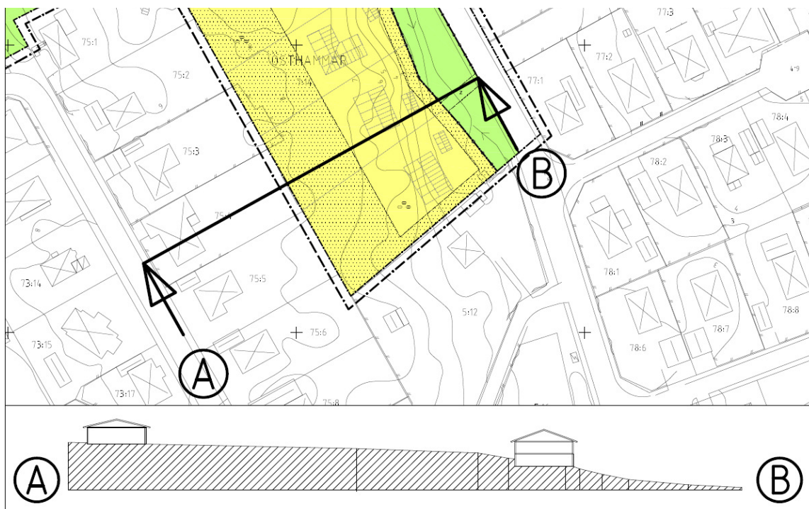
Figur 5 – Figuren visar en sektion mellan punkterna A och B. Sektionen är signifikant för områdets topografi.
