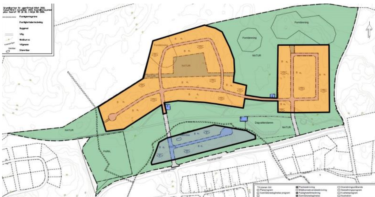
Figur 22: Plankarta med indelning av områden utifrån föreslagna dagvattenanläggningar. Dagvatten från det orangea området föreslås renas och fördröja i svackdiken och dagvattendamm. Dagvatten från det blåa området föreslås renas och fördröjas i svackdiken.
