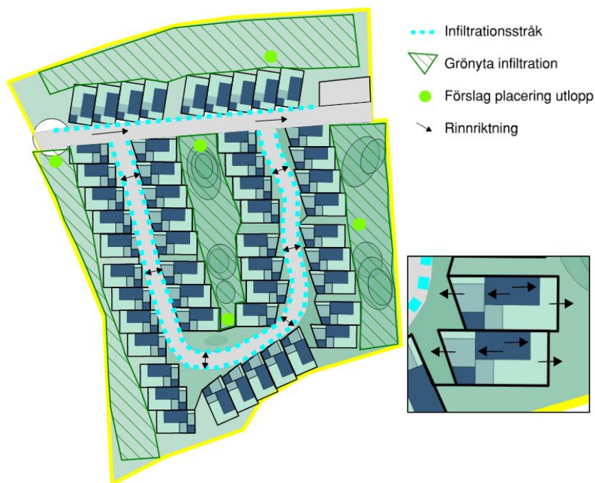
Figur 5-2. Principskiss över systemlösning för dagvattenhantering.
