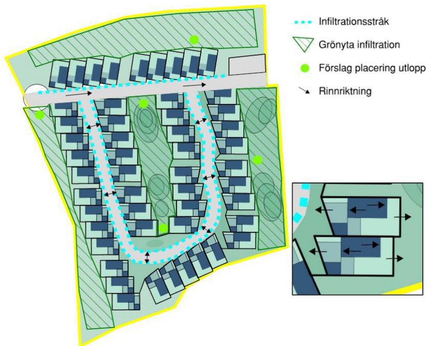
Figur 197, Principskiss över systemlösning för dagvattenhantering.
