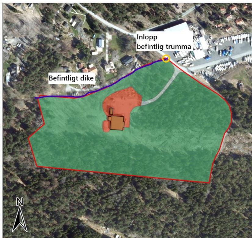
Figur 10. Befintligt dike (blått vattendrag) och trummans läge (gul markering).
