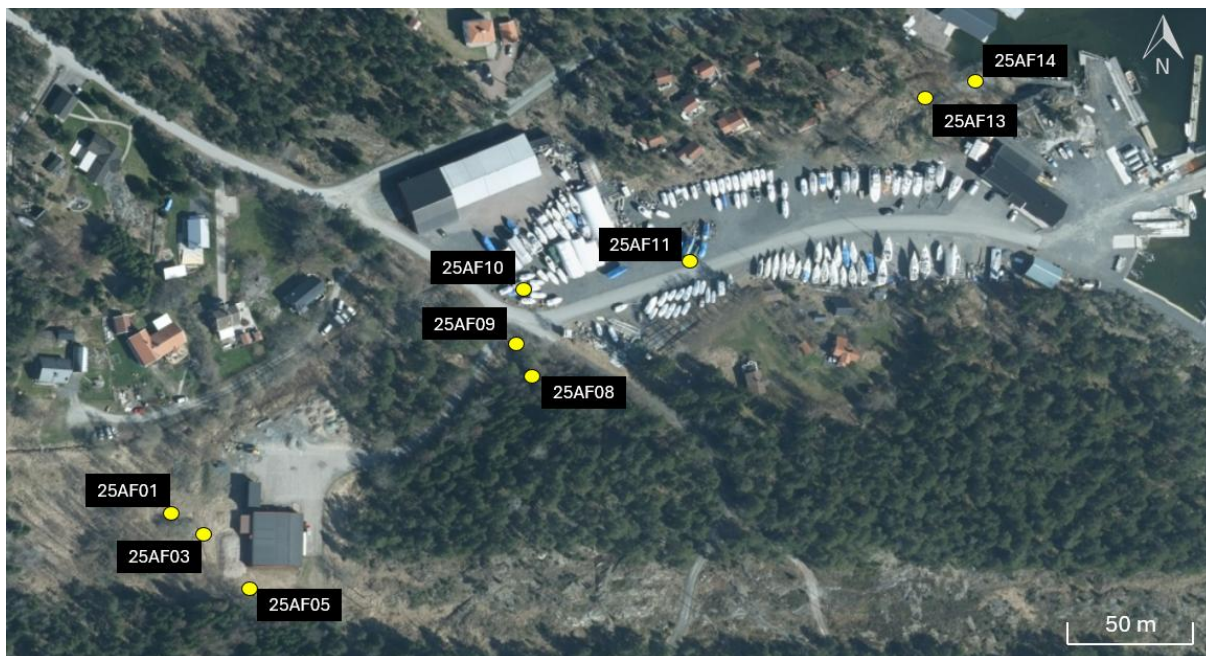
Figur 2. Översiktskarta över undersökningsområdet för genomförd markprovtagning i området för planerat avsaltningsverk med tillhörande intagsledningar och utbyggnation av avloppsreningsverk. Provtagningspunkter för jordprov är markerade med gul prick.
