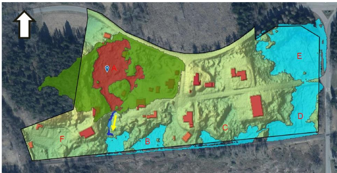
Figur 9. Avrinningsområde (grön) och utbredning (röd) av lågpunkt i område A. Gul pil visar flödesriktning vid brädning över vägen med vall-funktion mellan område A och B.
