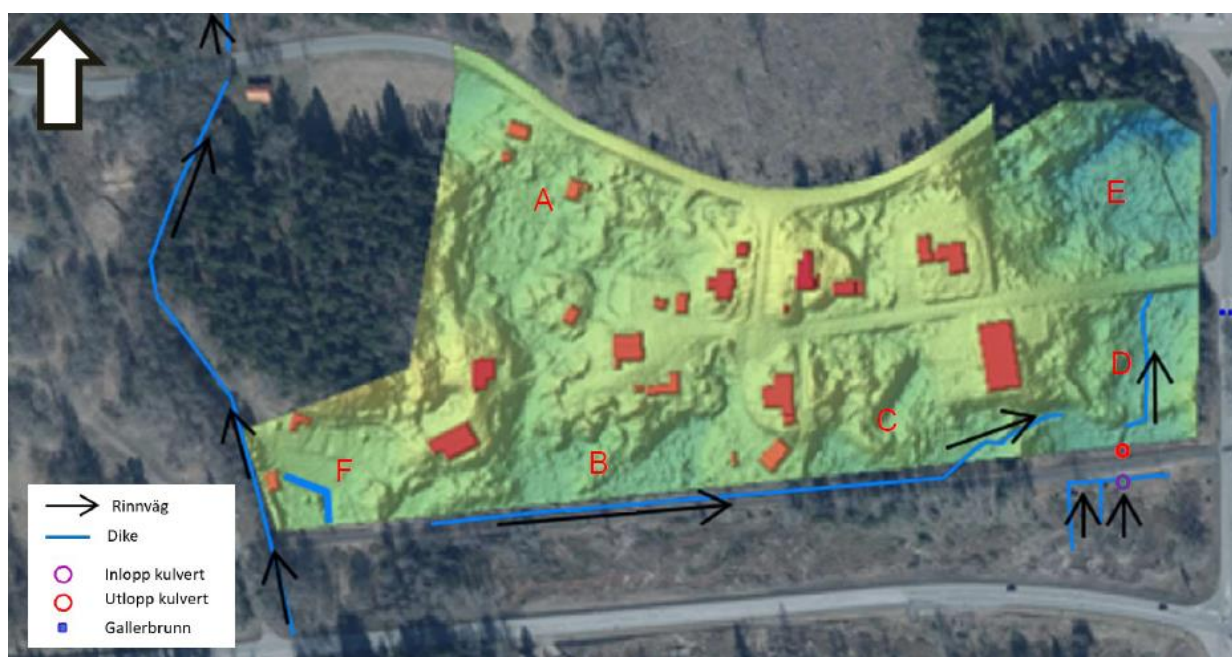
Figur 14. Topografisk karta över planområdet med inventerade diken och kulvert markerade samt flödesriktningar.
