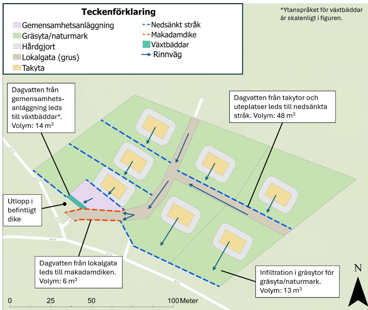
Figur 15. Systemlösning för dagvattenhanteringen inom planområdet. Utformningen av diken och nedsänkta stråk i figuren är endast schematiska.
