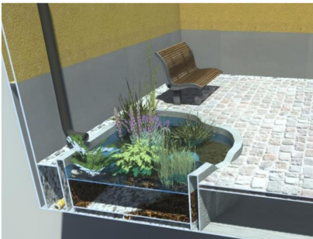
Figur 14. T.v. principskiss och t.h. exempelbild av nedsänkta växtbäddar (källa: Nacka Vatten och Avfall, u.å.).
