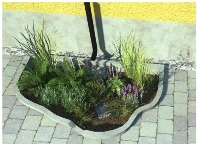
Figur 14. T.v. principskiss och t.h. exempelbild av nedsänkta växtbäddar (källa: Nacka Vatten och Avfall, u.å.).
