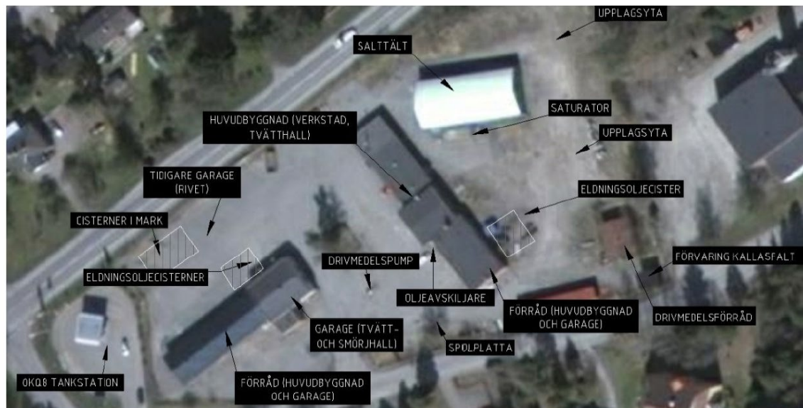
Översiktbild över undersökningsområdet. Förklarande text över Vägverkets historiska verksamhet på platsen.
