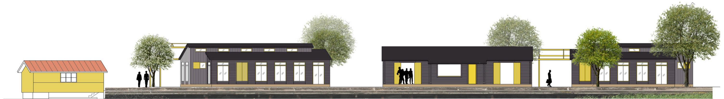
Parkbodar vid Fruktlunden med falugrå väggar och detaljer, gula luckor och tak i papp och plåt
