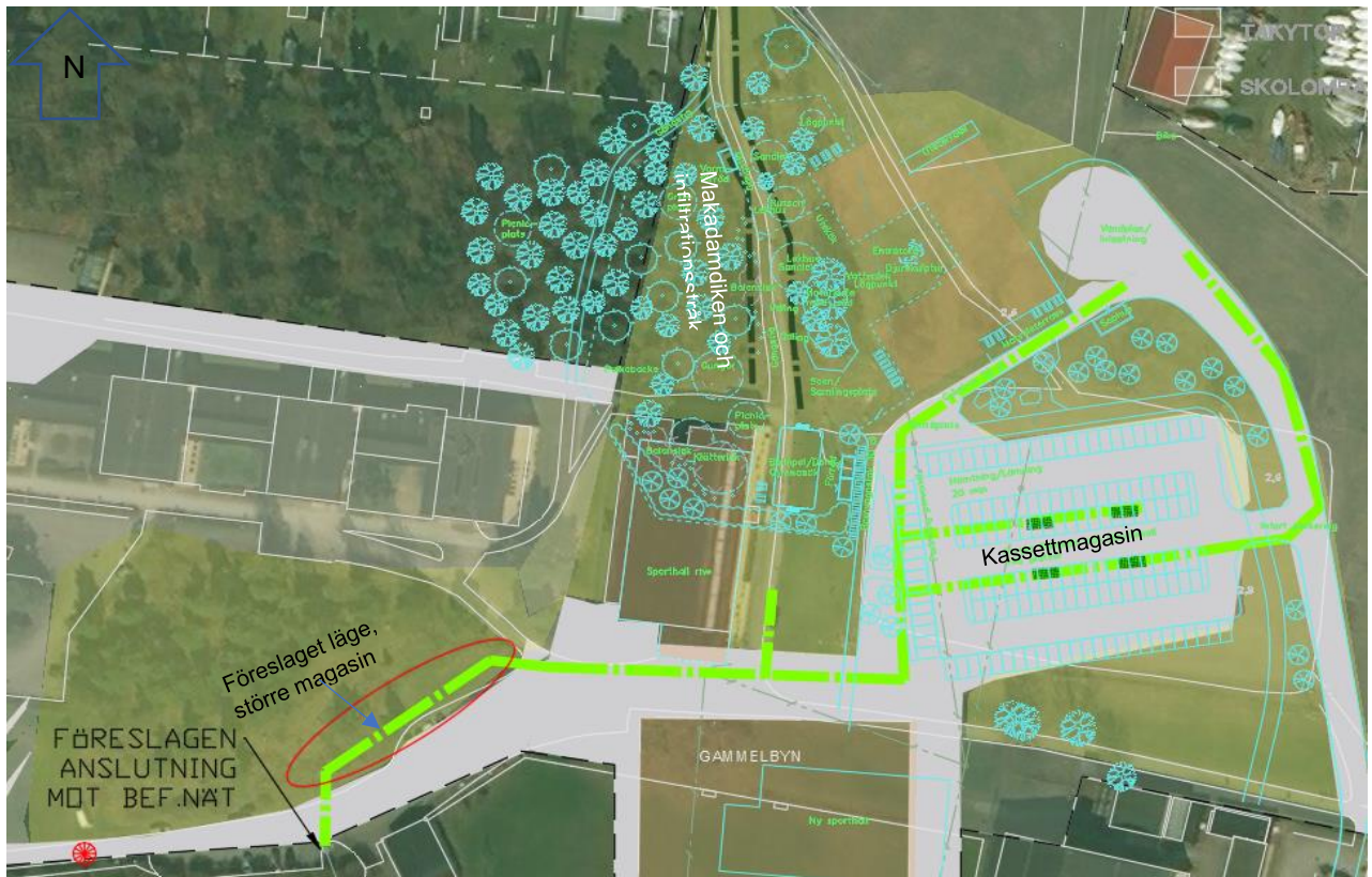
Figur 14. Principskiss dagvattensystem efter exploatering. Föreslagen anslutning av bräddutlopp mot befintligt ledningsnät
