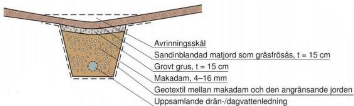
Figur 16. Principskiss makadamdike (Svenskt Vatten AB, 2011)
