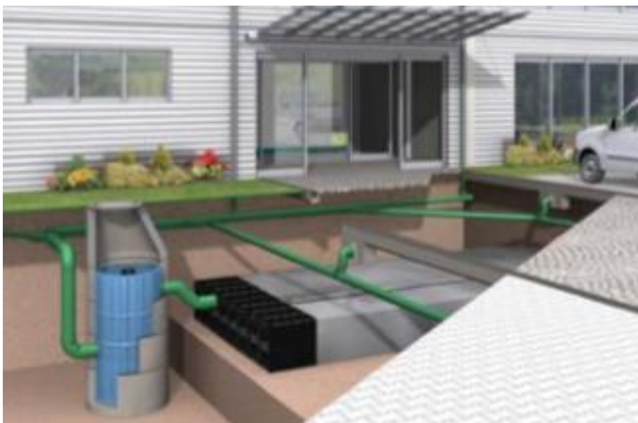
Figur 17. Principskiss för kassetmagasin följt av en filterbrunn (Plastinject Watersystems, 2019).
