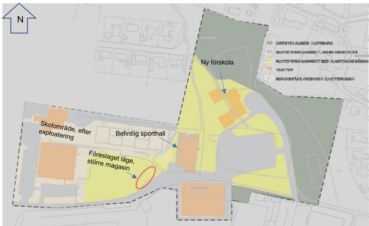
Figur 11. Föreslaget läge för en lägsta lågpunkt till ett samlat lokalt omhändertagande av dagvatten inom kvartersmark, framgår av röd ellips.
