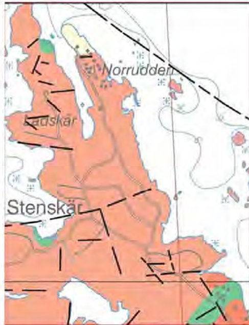
Figur 2. Berggrundskarta. Röd färg markerar äldre rödaktig granit. Gröna områden består av amfibolit och ljusgula av sura vulkaniska bergarter. De svarta strecken är grovt tolkade sprickzoner.
