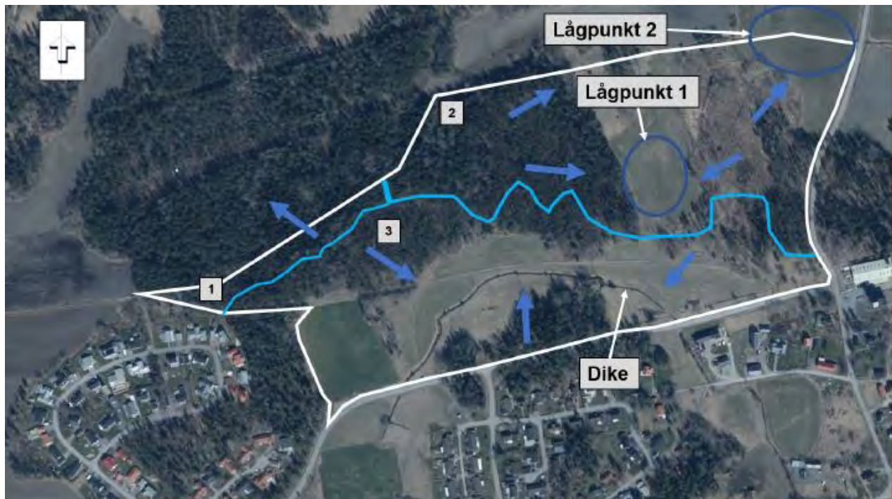
Figur 18: Områdesbild med ytavrinning för dagvatten, pilarna motsvarar vattnets flödesriktning.
