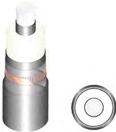
Figur 14 Markkabelns uppbyggnad och genomskärning
