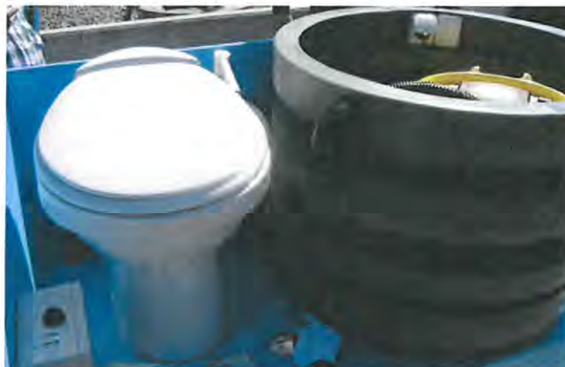
Figur 10. Exempel på toalettsystem med vakuumtoalett och sluten tank (uppställt för demonstration). Elektronikbox för styrning längst ned till vänster, till höger uppsamlingstank med vakuumenhet.
