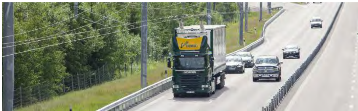
Bild X Demonstrationsprojekt i Sandviken med luftledningarna för eldriven godstransport, bild från Trafikverket.
