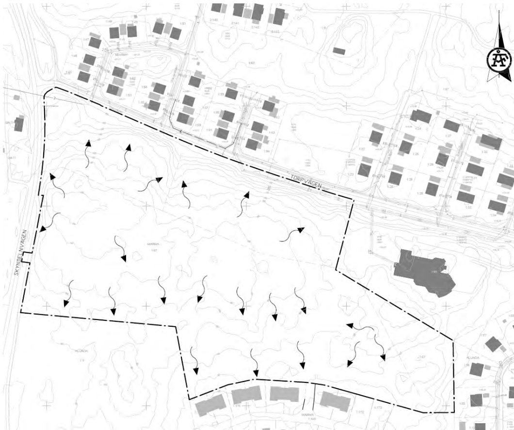
Figur 4. Översiktlig illustration över befintlig avrinning i planområdet.
