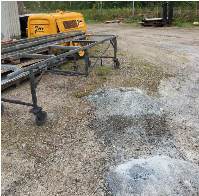
Figur 4. Rester av färg från målning av modulbyggnaderna väster om byggnaden.
