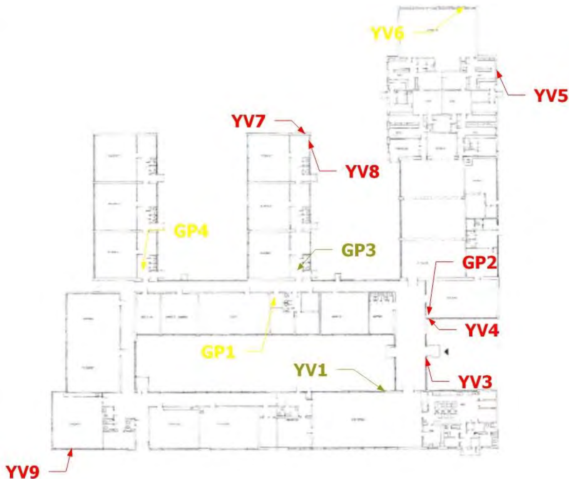
Figur 5 ritning över huvudbyggnad med utförda konstruktionsingrepp i golv och väggar
