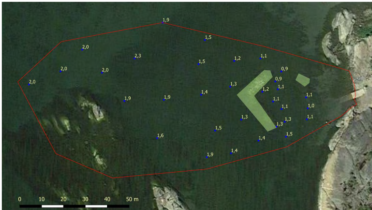
Figur 2. Det inventerade vattenområdet inramat med rött. De blå punkterna anger djupmätningar med djupet i meter. De grönskuggade ytorna visar läget för de stenkistor som anlades för kol- och vedutsklepning från Gräsö till Forsmarks bruk. Vattendjupet här är endast runt halvmeter.
