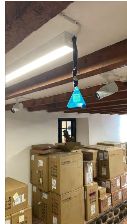
Passiva provtagare för undersökning av inomhusluft
