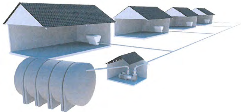
Figur 14. Principskiss över ett gemensamt vakuumsystem för klosettavatten. Källa: Jets.
