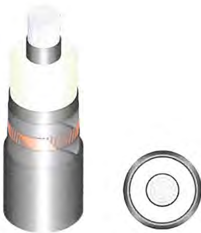
Figur 14 Markkabelns uppbyggnad och genomskärning
