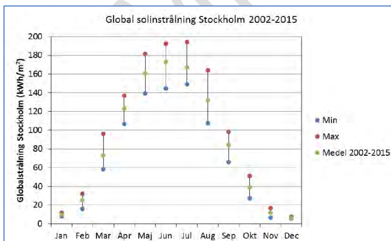
Bild X. Elproduktionen från solceller följer solinstrålningens intensitet, SMHI-data i diagram från utvärdering av Sveriges första MW-solcellspark, Bengt Stridh, Mälardalens högskola 2016.
