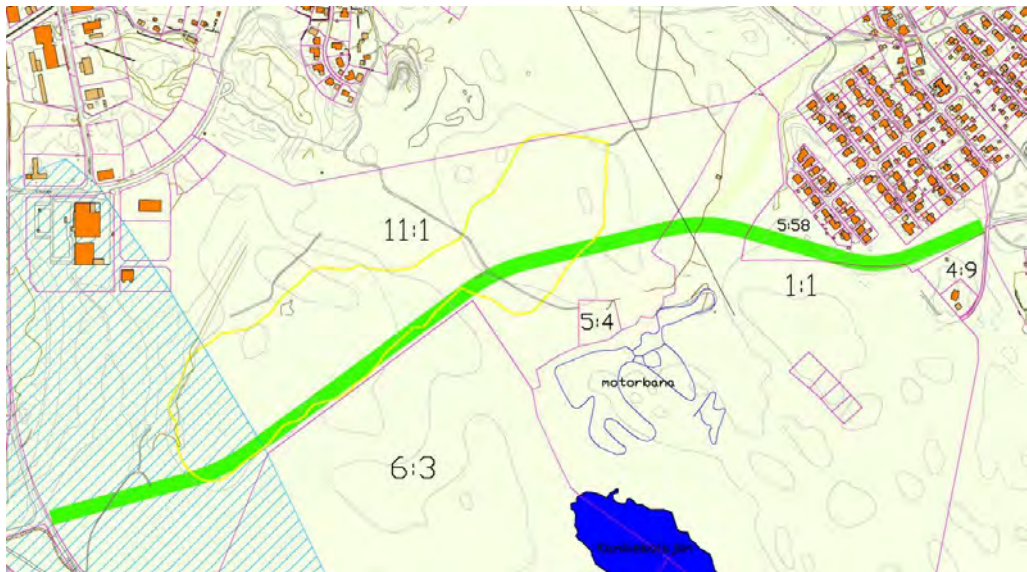
Bild 2: Föreslagen vägkorridor om 30 meter i grönt, inritade fastighetsgränser samt höjdkurvor. Vidare visar den gula linjen elljusspåret, den blåa motorbanan och det blågraderade området ett vattenskyddsområde.
