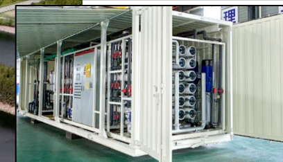
Avsaltningsanläggning – Konstruktion samt tillverkning pågår av containerlösning
